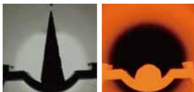
当社ではJIS M 8801.12 (灰の溶融性試験方法)に基づき、酸化性(大気)雰囲気の中(最高温度1500℃)で成型した試験錐を加熱し、デジタルビデオにより溶融状況を直接観察・撮影して軟化点・融点・溶流点を測定します。
