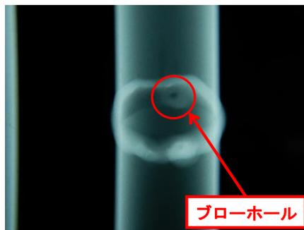
放射線透過試験(突き合わせ溶接部)
