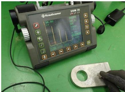
超音波探傷試験(SUS材)
