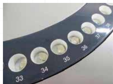
オートサンブラに試料を装填した状況
