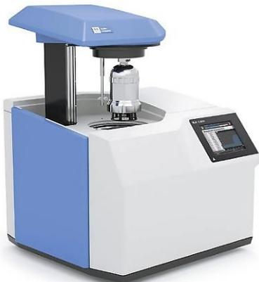
鋼製のポンベ内に試料を入れ、内圧が3MPaになるまで酸素を充填して加圧状態にします。このポンベを水槽内に設置した後、高電圧をかけて点火して試料を完全燃焼させます。燃焼時に発生した熱をポンベの周囲の水に吸収させ、水温上昇の変化量と水量から発熱量を算出します。この熱量は総発熱量です。別に水分、水素含有量を測定して真発熱量を算出することができます。真発熱量は石炭の燃焼のみから得られる熱量となります。基本的には燃焼計算を行う場合には真発熱量が使われます。
